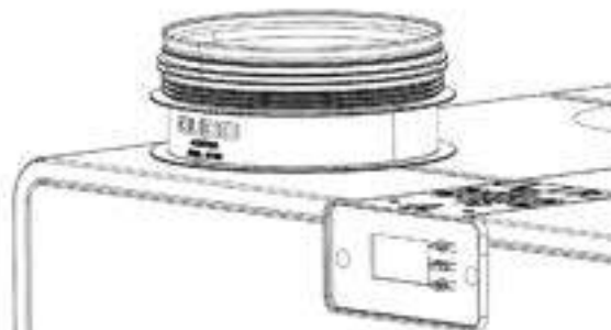
Spingere il manicotto di connessione nell'unità fino alla flangia di arresto
